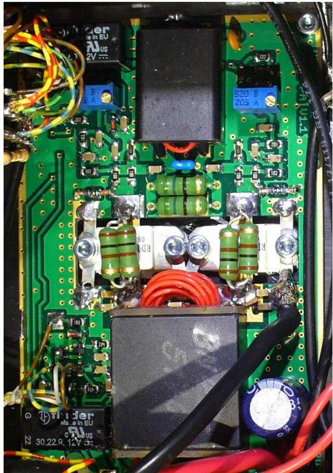
lange genommen, ich habe mich für 3,5mm entschieden, damit ist der Abstand der Endstufentransistoren zur Platine etwas günstiger. Nächstes Problem – die Gegenkopplung. Man sollte 2 x 100 Ohm Widerstände parallel schalten und die dann mit einem 100nF SMD-Kondensator in Reihe
