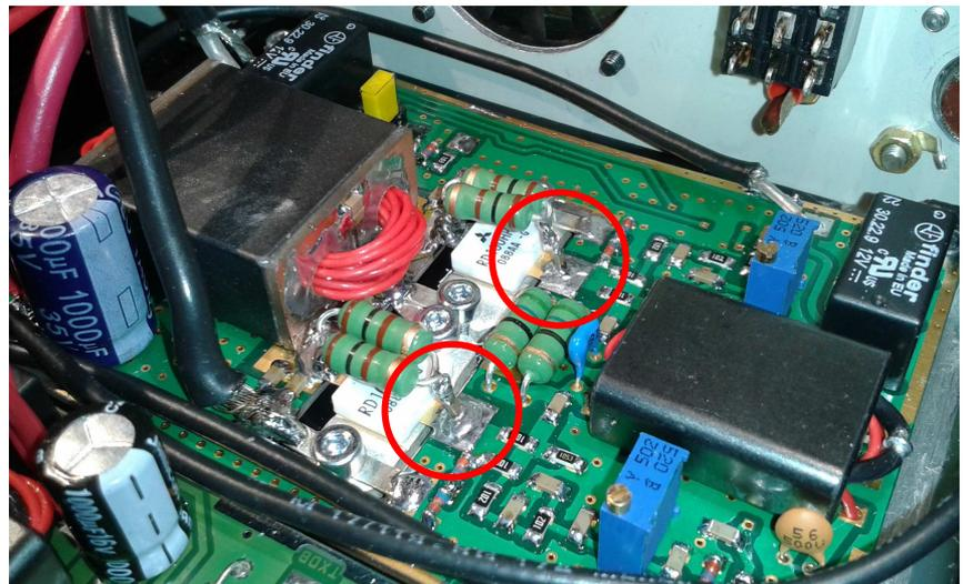
so kurz wie möglich zwischen Drain und Gate löten. Bei meinem Aufbau sind mir zweimal die 100nF SMD-Kondensatoren abgebrochen, beim nächsten Mal werde ich 3 bis 4 SMD-Kondensatoren zu einem Paket zusammen löten, die dann 100nF ergeben und hoffen, dass Sie nicht wieder abbrechen.
